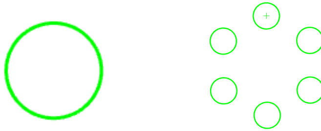
< 원형 배열로 (Polar Array) 명령으로 생성된 형상 >
